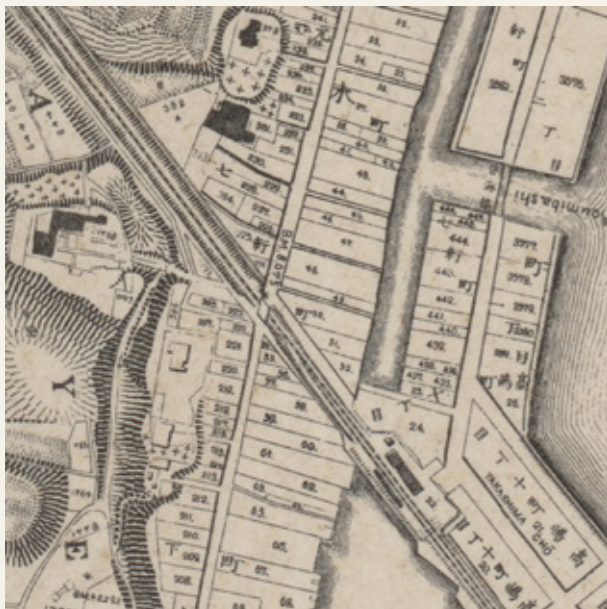
④ 青木橋付近の部分 崖や掘り割りなど、土地の起伏はケバ線で表現されている。その線の向きは傾斜の方向に対して平行で、太さは傾斜の角度に比例する。
