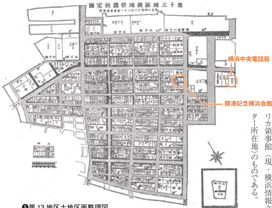
⑤第13地区土地区画整理図 『横浜復興誌 第二編』(昭和7年)より 黒く塗られているのが道路拡幅部分。
